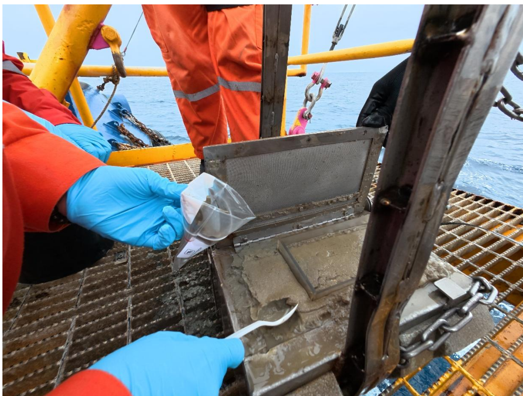
รูปที่ 4-6 การเก็บตัวอย่างตะกอนพื้นทะเล
